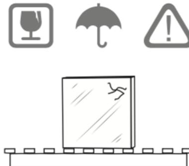
Las piezas de piedra requieren un manejo cuidadoso durante su almacenaje, manipulación e instalación para evitar rupturas, astillado en los bordes o rayado en la superficie. Almacene las piezas bajo techo, sobre una estiba, siempre en posición vertical y con las caras brillantes enfrentadas.
